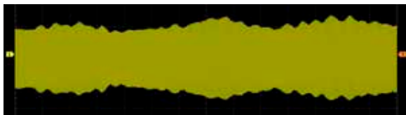
Figura 11 – Semnalul de radiofrecvență captat de antenă
